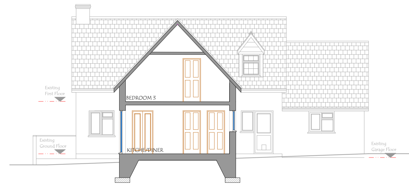
EXISTING SECTION A-A 1:100
